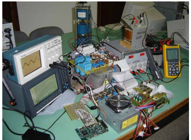
Figura 11. Prototipo del convertidor CA/CA directo.
