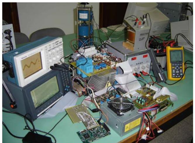
Figura 11. Prototipo del convertidor CA/CA directo.
